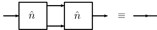
Figura 1.4: Primera secuencia de aparatos de Stern Gerlach. El efecto del campo que separa el haz incidente puede revertirse. La caja que tiene dos entradas y una salida representa la disposición de campos magnéticos que revierte la aplicación del aparato de Stern Gerlach en la dirección \hat{n} .
